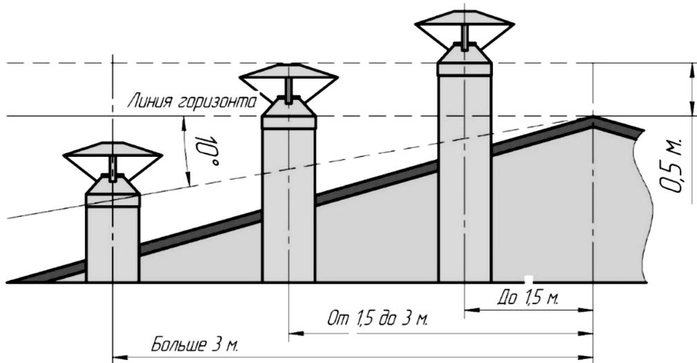
– При монтаже дымовой трубы в зданиях с кровлей из горючих материалов, обеспечить трубу искрогасителем.
